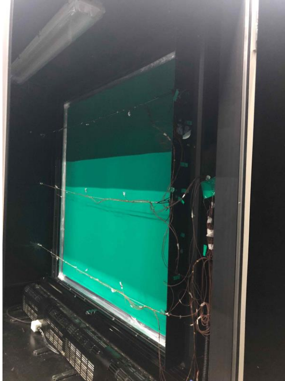
그림 5 - 어닝의 태양열 취득률 시험 시료 설치
